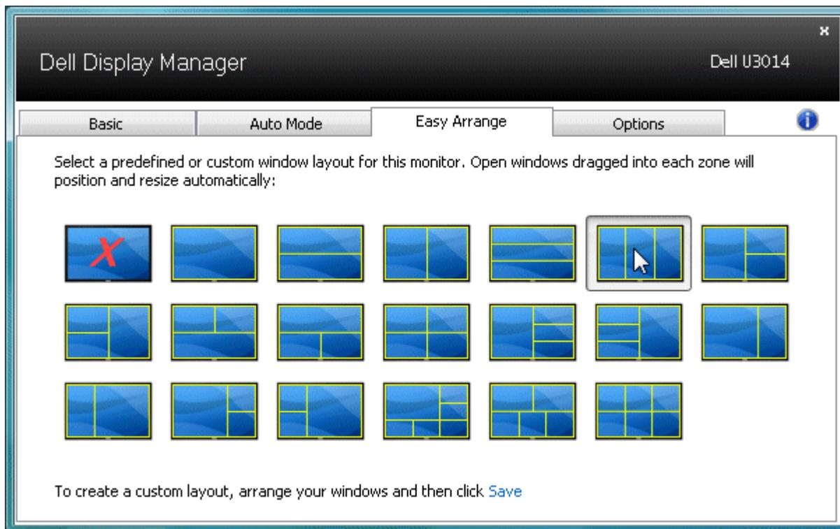
カスタムウィンドウレイアウトを作成するには、最初にデスクトップ上で最大10のウィンドウのサイズと位置を決定し、Easy Arrangeの保存リンクをクリックします。ウィンドウのサイズと位置がカスタムレイアウトとして保存され、カスタムレイアウトアイコンが作成されます。
