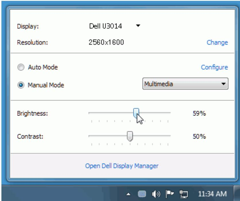
クイック設定のダイアログボックスからは、Dell Display Manager の高度なユーザー インターフェイスにもアクセスできます。ここからは、基本的な機能を調整したり、自動モードを設定したり、その他の機能にアクセスしたりすることが可能です。
